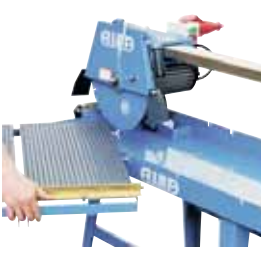
Mesa desmontable, para facilitar la limpieza Removable table to facilitate the inside cleaning Table démontable pour faciliter le nettoyage
