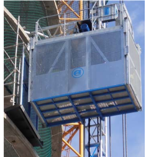
ACABADO EN ACERO GALVANIZADO
