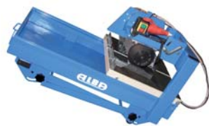
TVR con patas abatibles y ruedas. TVR with foldable legs and wheels. TVR avec pieds abatibles et roues.
